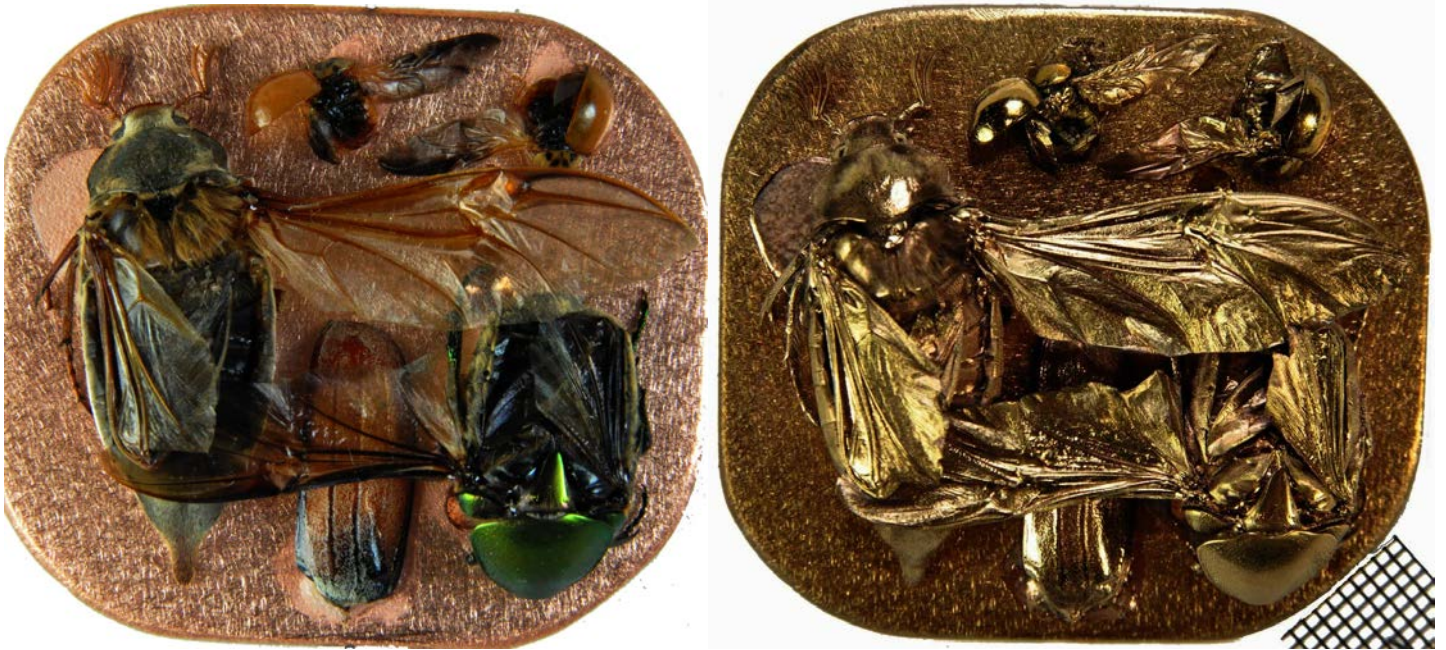
Rys. 1. a, b. Materiał biologiczny, pierwotny i przygotowany do skanowania SEM.
